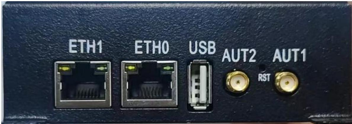
图 2-1 DT-BOX-20/21 上方接线图
