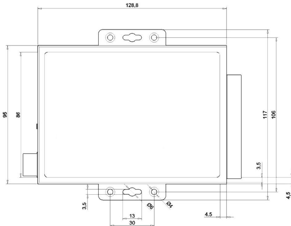
图 3-2 DT-BOX-36 外形尺寸&挂耳安装孔位图（俯视图）
