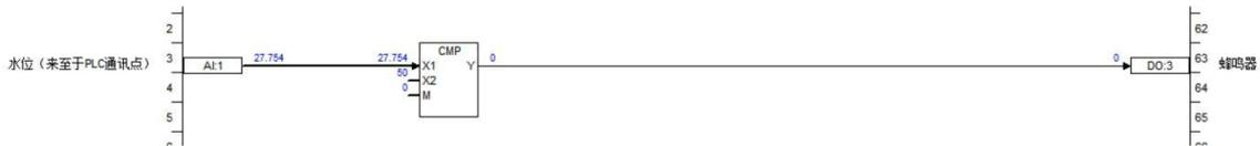
图 3-4 液位超过 50 蜂鸣器报警的示例
