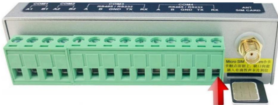
图 2-2 Micro SIM 卡插入示意图
