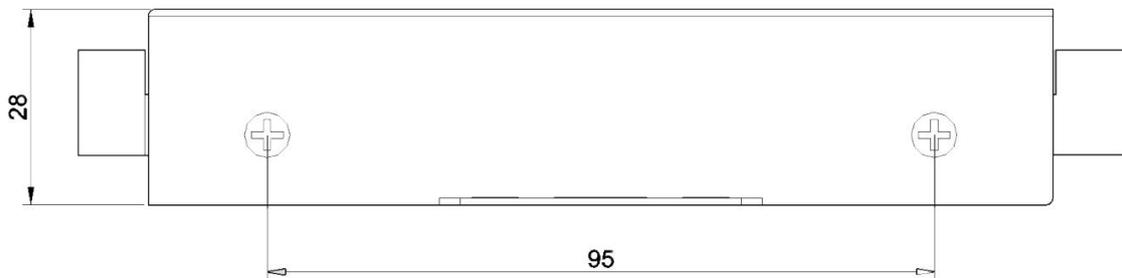
图 3-1 DT-BOX-36 外形尺寸&挂耳安装孔位图（左视图）
